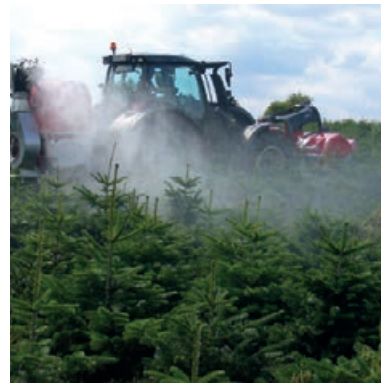
Abbildung 12: Gebläsespritze mit hoher Abdrift
