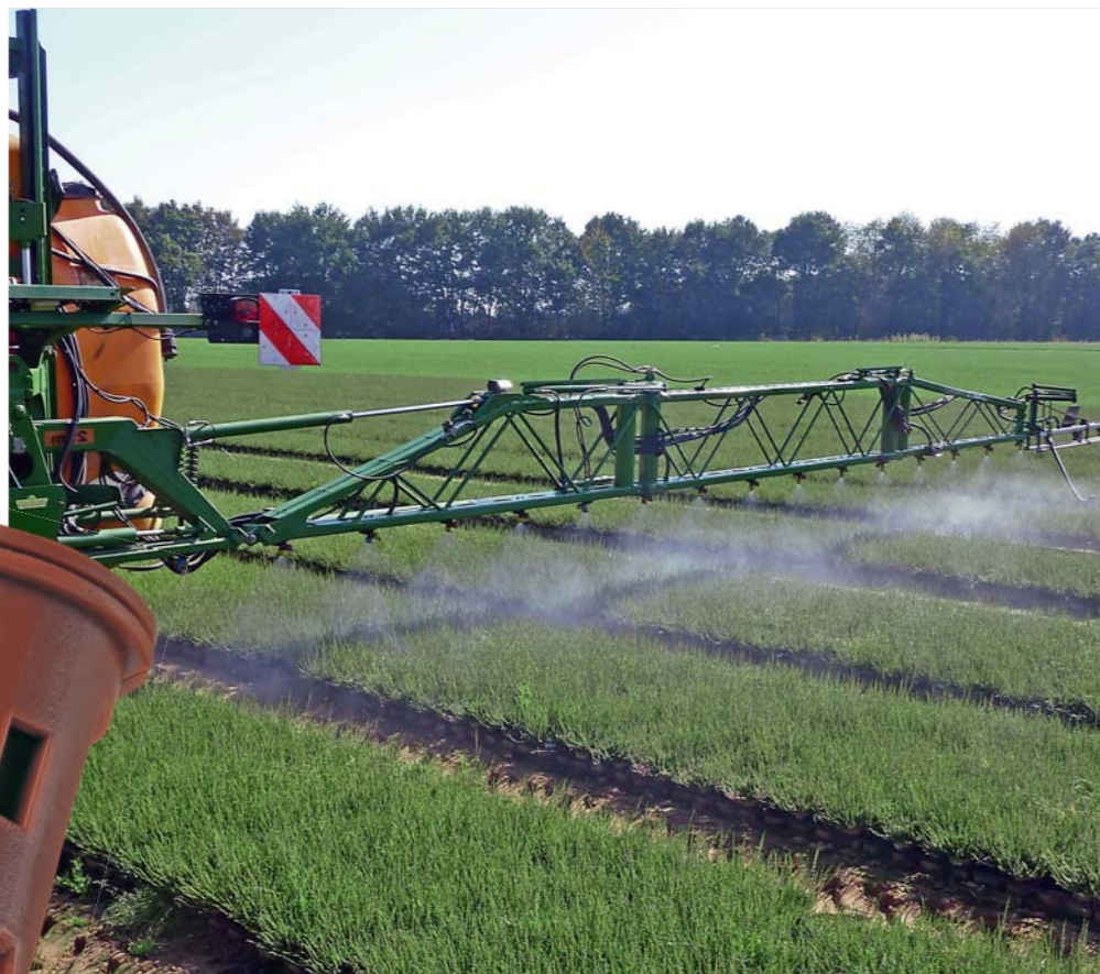
IDK-Düsen an der Anbauspitze links im Bild, rechts abdriftgefährdete Standarddüsen,
