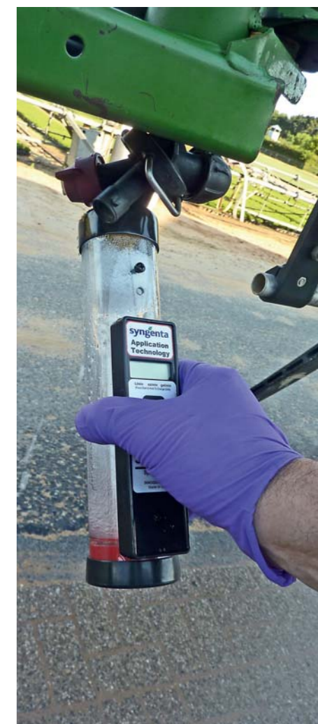
Spritzbrühe: Auslitern & kalibrieren.
