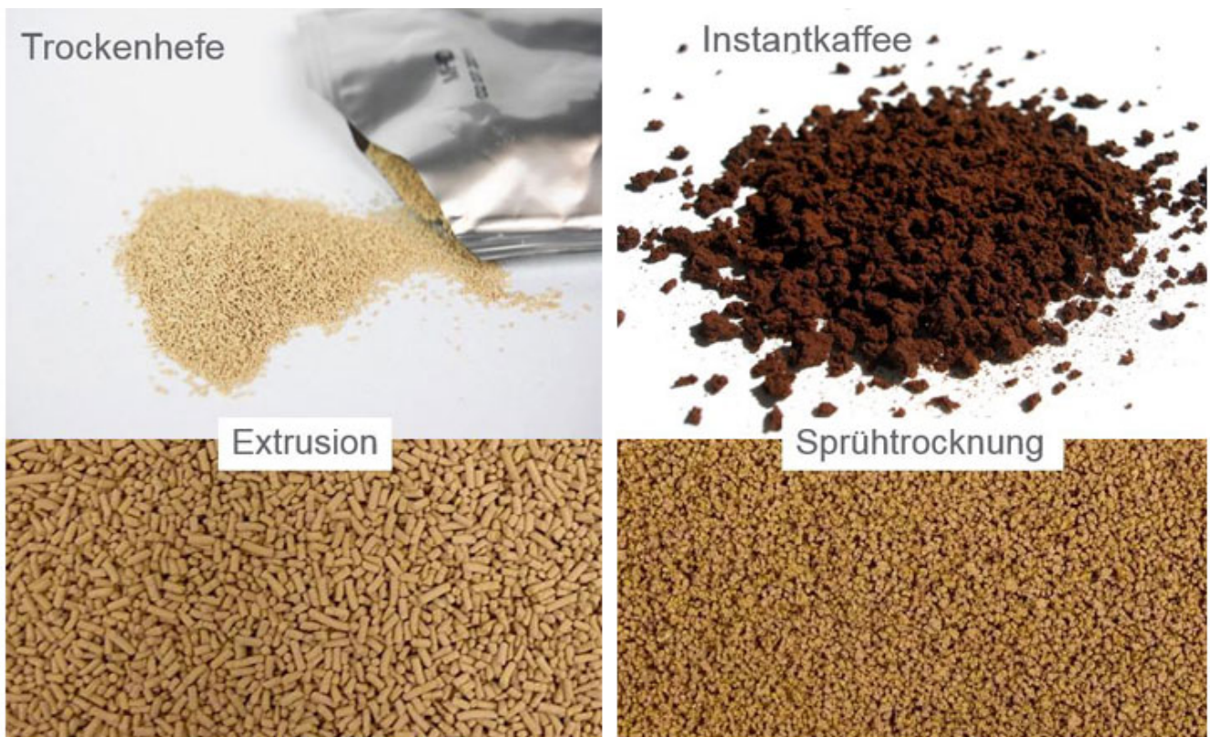
Verschiedene Herstellungsverfahren für eine WG Formulierung: Extrusion und Sprühtrocknung
