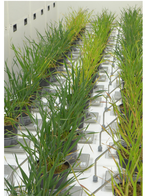
Abb. 3: Transpirationsmessungen für Trockenstressuntersuchungen mittels eines automatisierten Bewässerungs- und Beregnungssystems.
