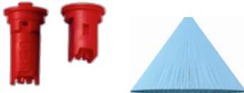
Luftinjektor-Hohlkegeldüsen reduzieren bei einem Spritzdruck von 3 bis 10 Bar die Abdrift im Vergleich zu konventionellen Hohlkegeldüsen um bis zu 75 Prozent.
