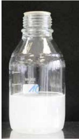
**Abb. 4: Emulgierverhalten eines modernen Suspensionskonzentrates am Beispiel von Vertimec Pro (Aufnahme nach 24 Stunden Standzeit)**
