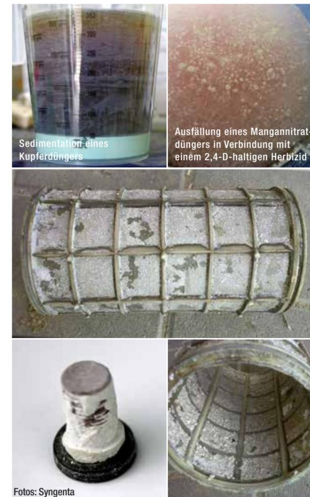
Abb. 5: Verstopfte Spritzen- und Düsenfilter
